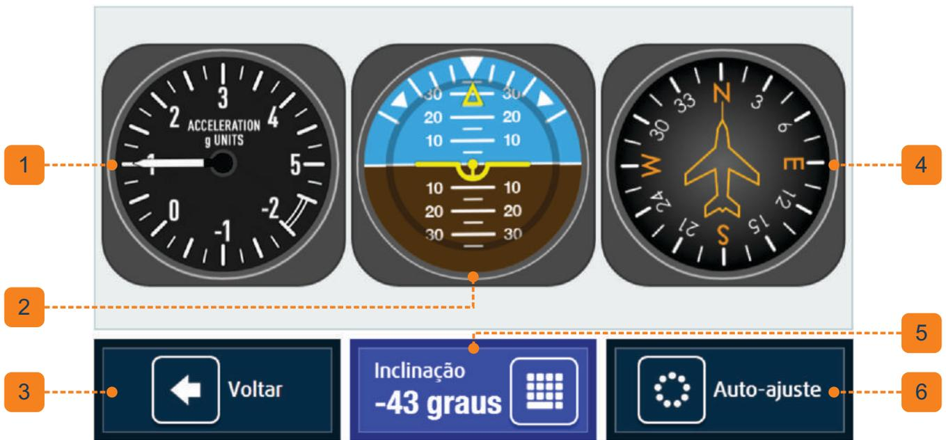
Imagem 12: Tela de ajuste do giroscópio
