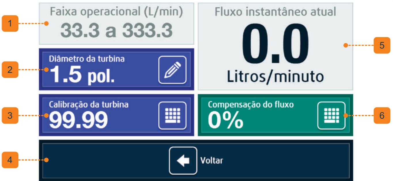
Imagem 09: Tela de configuração de turbina
